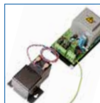
SB52 Strömförsörjning 230 VAC till 12 VDC & 12 VDC
